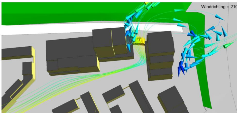
Figuur 9 Stroomlijnen van de lucht, vanuit windrichting 210, die de versnellingen weergeven tussen de gebouwen van de ontwikkeling. Een oranje/geel/groene kleur geeft een hogere versnelling weer dan een blauwe kleur.
