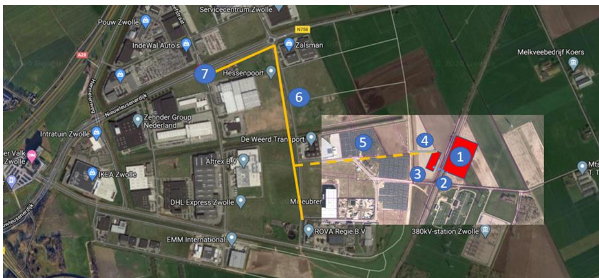
Inrichting vergisterlocatie (1), mest- en biogasleiding onder het spoor (2) en mestinvoerpunt (3)
